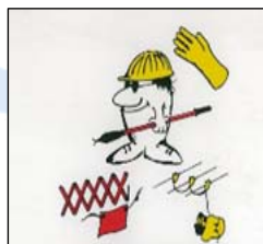
2. Retirar puesta a tierra y en cortocircuito
